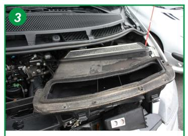
Dégager l'ensemble du boîtier filtrant, par la gauche dans un premier temps puis par la droite pour le sortir totalement.
