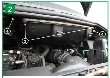
Dévisser les deux vis d'un quart de tour (3). Dégrafer les quatre sauterelles (4) Retirer le boitier en le tirant vers l'avant
