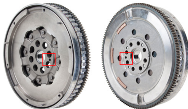
Bild 1: Bezugsmarke des Zweimassenschwungrads
