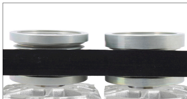
1. ábra: Balra az 535 0202 10 cikkszámú generátor szabadonfutó 6 bordával - jobbra az 5 bordás generátor szabadonfutó
