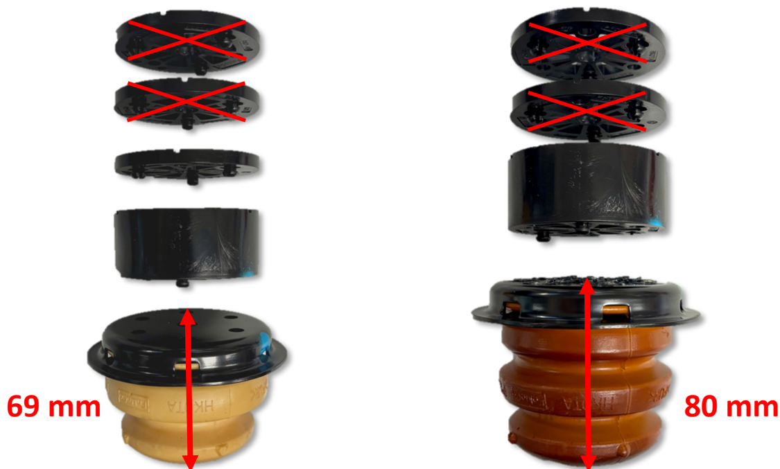
Abb. 4: Einstellmaß 20 - 30 mm: Entfall eines Distanzstückes (Abbildung ähnlich) Fig. 4: Adjustment dimension 20 - 30 mm: discard one spacer (Picture may vary)
