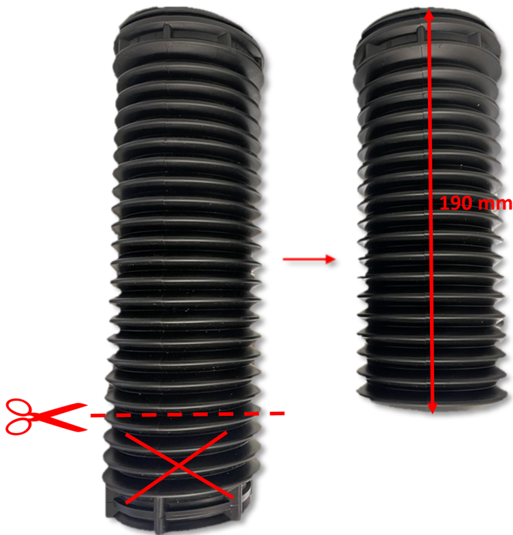
Abb. 1: VA Schutzrohr kürzen (Abbildung ähnlich) Fig. 1: FA shorten dust cover (figure may vary)
