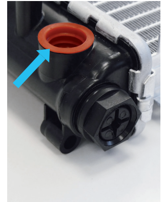
Resim 2: Manuel şanzımanlı araçlarda ek bağlantı kullanılmaz ve bir kör tapa ile kapatılır
