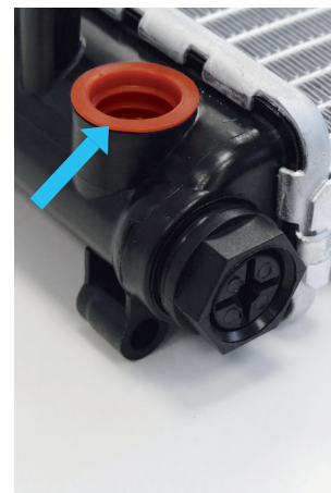
Иллюстрация 2: В автомобилях с механической КПП дополнительный разъем не требуется и перекрывается заглушкой
