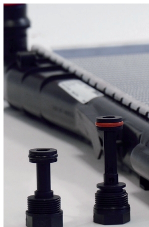
Иллюстрация 1: Короткие и длинные сливные пробки, которые прилагаются к радиатору охлаждающей жидкости
