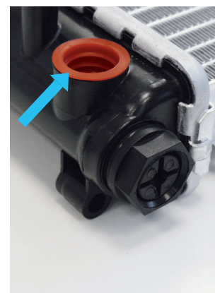
Figura 2: En vehículos con cambio manual, la conexión adicional queda sin usar y se cierra con un tapón roscado
