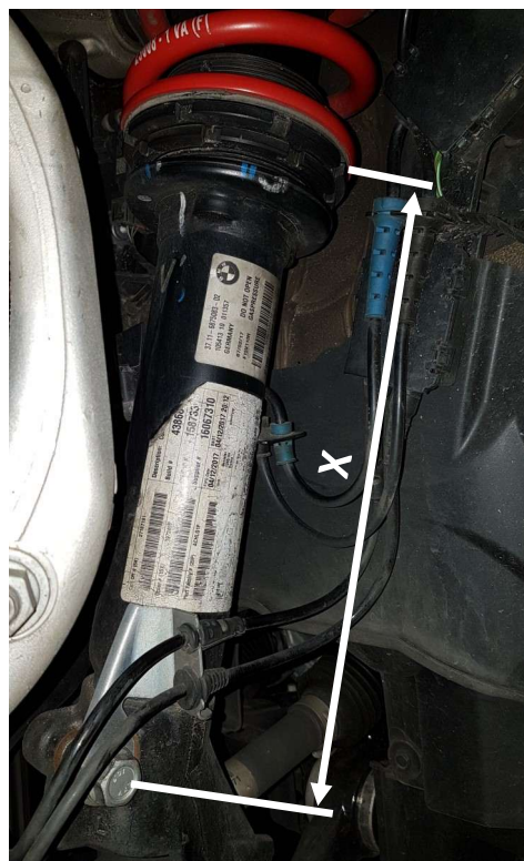
Abb. 4: Einstellmaß X VA (Abbildung ähnlich) Fig. 4: Adjustment dimension X FA (Fig. may vary)
