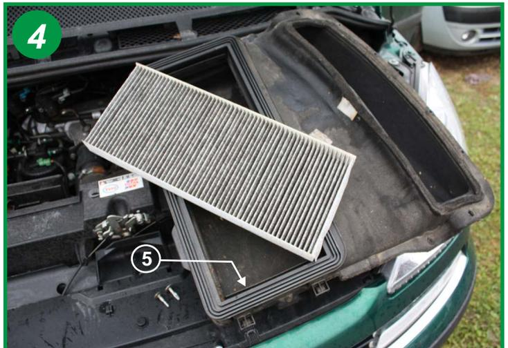
Extraire l'élément filtrant usagé et procéder à son remplacement, imbriquer les 2 premiers plis dans les nervures sur le boîtier (5). Le remontage s'effectue dans l'ordre inverse du démontage.
