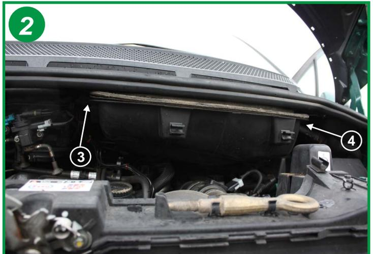
Repérer les 4 fermoirs (du type sauterelles) de chaque coté du boîtier (3 et 4), puis les 2 clips métalliques situés sur le devant. Tourner d'un quart de tour les 2 clips puis dégrafer les 4 fermoirs.
