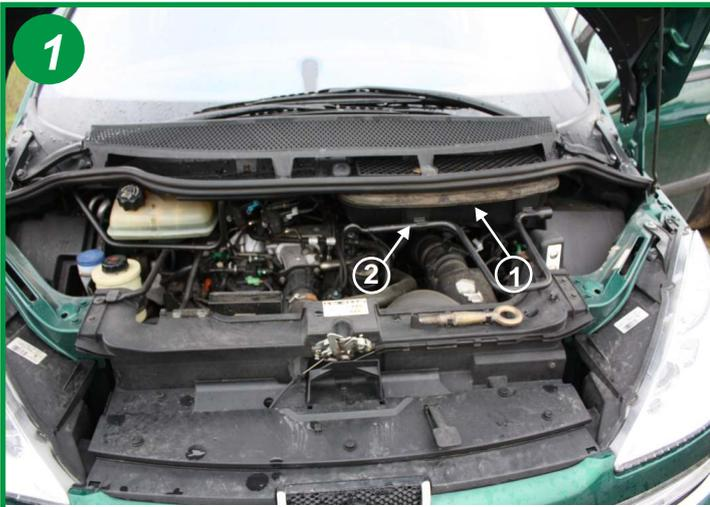
Le filtre d'habitacle est situé sous le capot moteur, coté conducteur, sous la baie de pare-brise (1). Retirer la manivelle (2).
