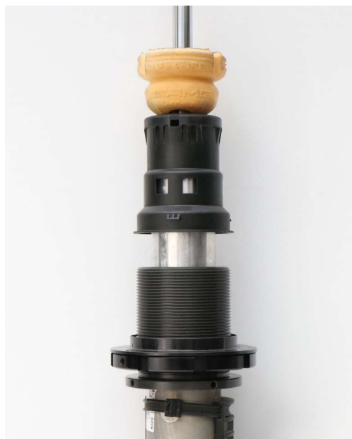
Abb. 2: Höhenverstellung und Abdeckkappe mont.
