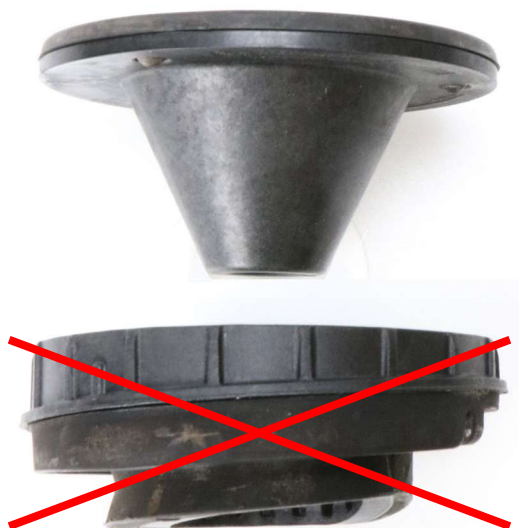
Abb. 4: Obere Federunterlage entfällt, Zentrierkegel wird wiederverwendet
