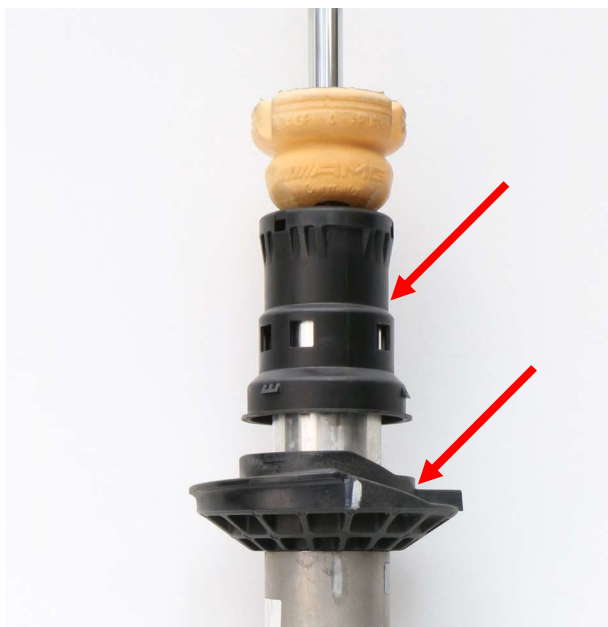
Abb. 1: Abdeckkappe und Federteller demontieren
