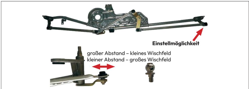
Vor der Montage des Wischergestänges muss der Wischermotor in die Nullposition gebracht werden. Durch Drehen des Exzenterbolzens kann die Größe des Wischfeldes eingestellt werden, um ein Anschlagen der Wischer zu verhindern.
