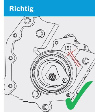
Danach die Kurbelwelle sechs Umdrehungen im Uhrzeigersinn drehen. Fixerdorn (Werkzeug Mot.582-01) in Schwungrad einsetzen. Kurbelwelle leicht vor- und zurückdrehen, um sicherzustellen, dass Fixerdorn richtig eingesetzt ist. Die Steuermarkierungen müssen fluchten. Fixerdorn entfernen.
