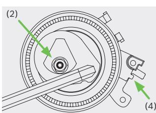
Spannrolle gegen Uhrzeigersinn drehen, bis Zeiger sich in Stellung (4) befindet (Maximale Zahnriemenspannung). Mutter (2) der Spannrolle mit 24 Nm anziehen.
