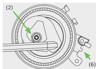
Spannrolle im Uhrzeigersinn drehen, bis Zeiger sich in mittlerer Stellung (6) befindet. Mutter (2) der Spannrolle mit 24 Nm anziehen.
