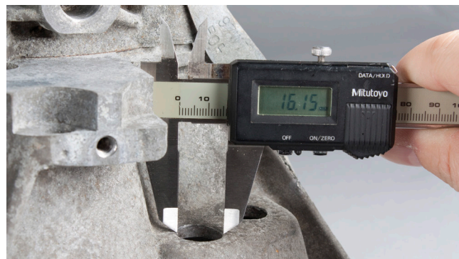
2. ábra: Ha az átmérő kisebb mint 21 mm, akkor azt legalább 21 mm-re, de max. 24 mm-re fel kell fúrni
