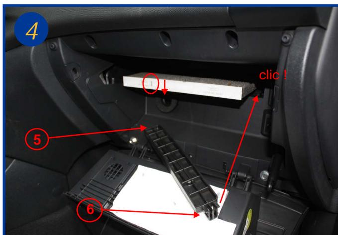
Sortir le filtre usagé, le remplacer (flèche vers le bas) replacer le couvercle du boîtier en positionnant tout d'abord la patte à l'extrémité (5) et en cliquant l'autre extrémité (6). Le remontage s'effectue dans l'ordre inverse du démontage.
