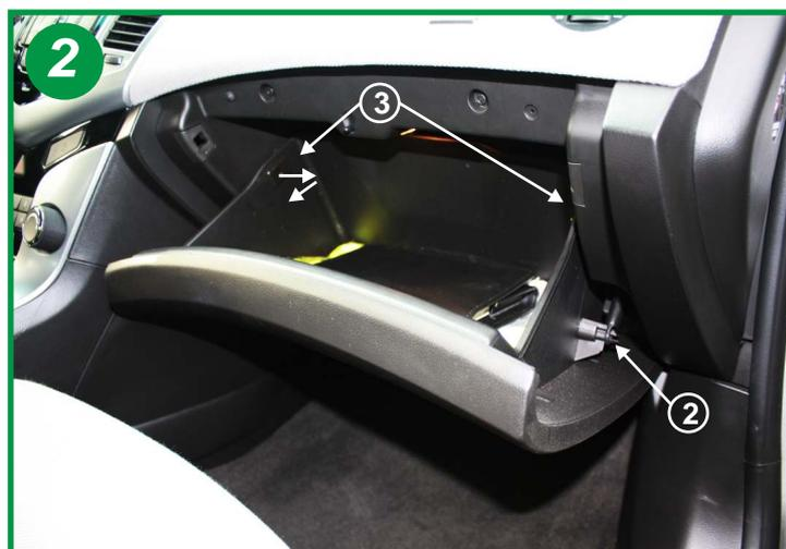
Ouvrir la boîte à gants, débrancher l'amortisseur de descente de boîte (2), dégager les 2 arrêteurs (3) en procédant dans le sens des flèches. Basculer le tiroir vers le bas.
