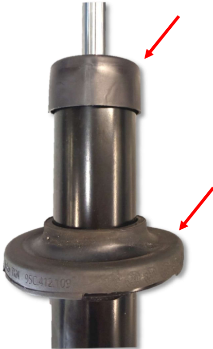
Abb. 1: Abdeckkappe und Federteller demontieren Fig. 1: Dismantle cap and spring plate
