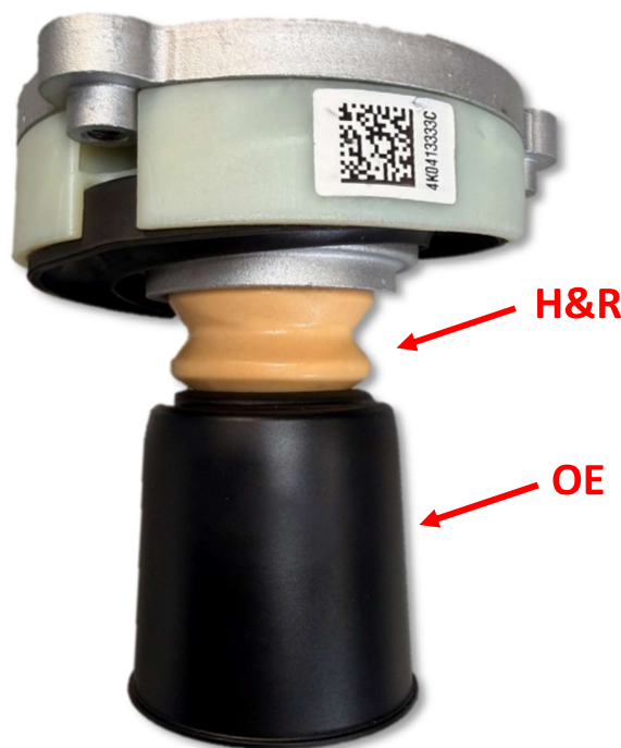
Abb. 3: H&R Anschlagpuffer mit OE Schutzrohr Fig. 3: H&R bump rubber with OE dust cover
