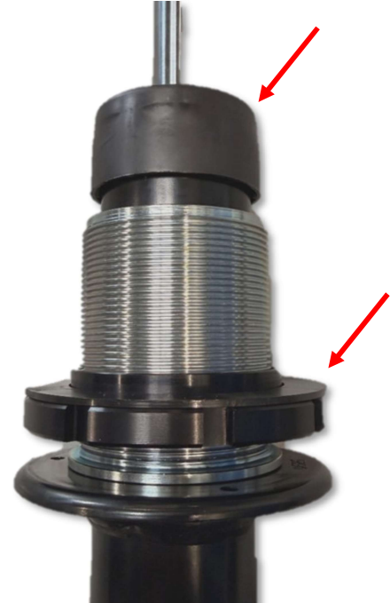
Abb. 2: Höhenverstellung und Abdeckkappe mont. Fig. 2: Mount the height adjustment and cap
