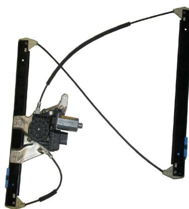
oem window regulator - lève-vitre original - Fernsterheber von oem - elevalunas original - levantator de vidro original - Γρύλος γνήσιος - alzacristallo originale
