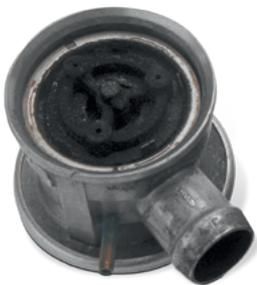
Повреждение под действием конденсата отработавших газов
