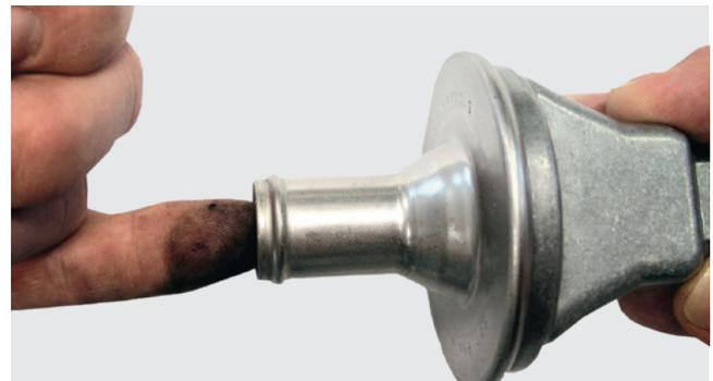
рис. 1 : Простое тестирование обратного клапана
