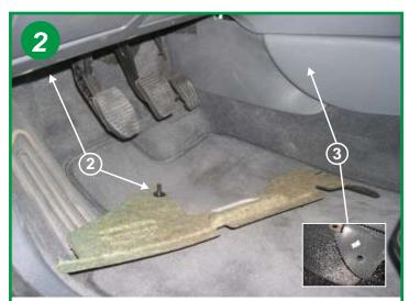
Retirer le cache situé sous le pédalier en déverouillant la vis de maintien (voir flèche 2). Retirer également le cache qui est parallèle à la console centrale en dévissant la vis qui se trouve derrière ce cache (flèche 3 voir encadré)
