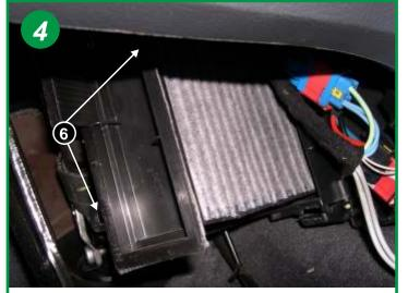
Dévisser les deux vis situées sur le couvercle tiroir de l'élément filtrant (flèche 6) pour extraire le filtre usagé. Le remontage s'effectue dans l'ordre inverse du démontage.
