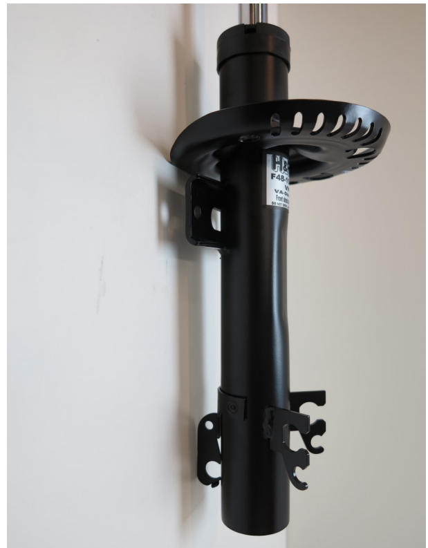
Bild 2: Federbein VA mit Blechhaltern
