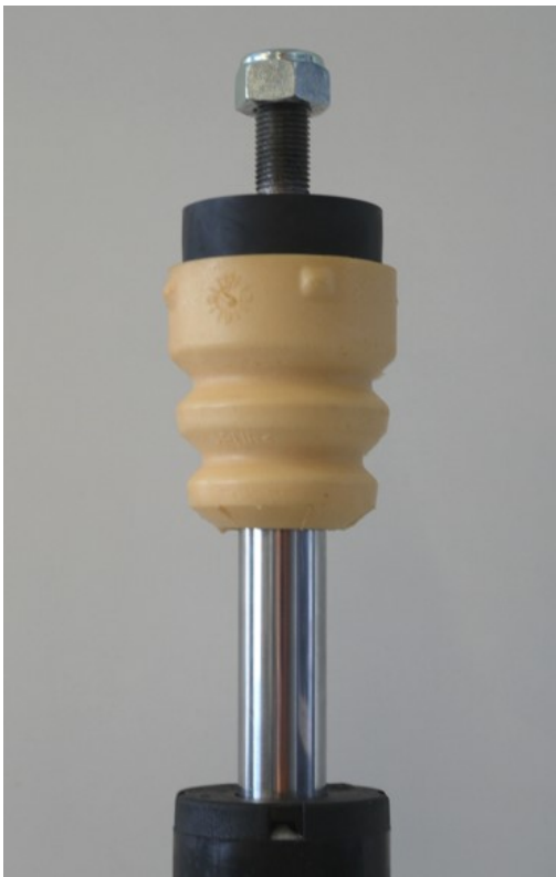
Bild 1: Montage der schwarzen Kunststoffscheibe
