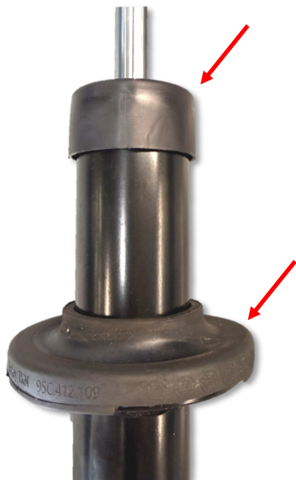
Abb. 1: Abdeckkappe und Federteller demontieren
