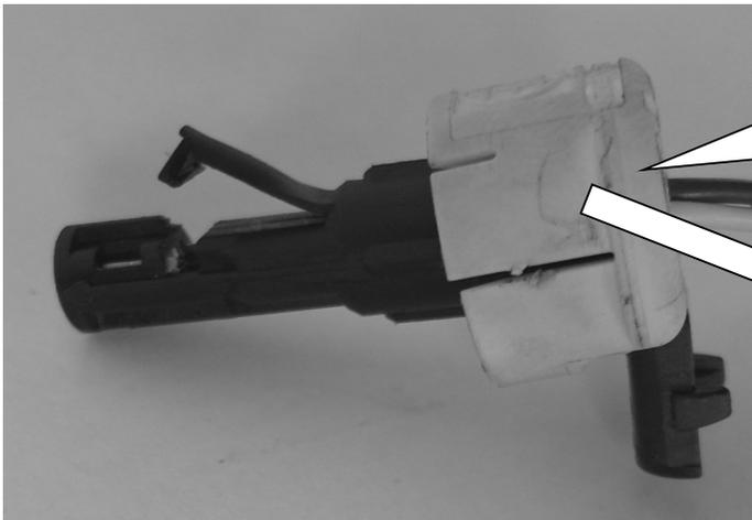
2. Steckersicherung öffnen und Originale Dämpferleitungen mit geeignetem Werkzeug aus dem Stecker ausspinnen.
