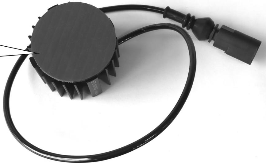
Dämpfersteuerungsleitung in den mitgelieferten Elektroniksatz einstecken. Auf die korrekte Verriegelung des Steckers achten! Stilllegungen auf das Karosserieblech Fahrzeugmittig aufkleben. **WICHTIG: Oberfläche muss Staub- und Fettfrei sein.**
