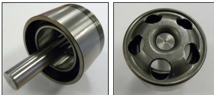
Fig.4: cuscinetto esterno Ø52 mm.
