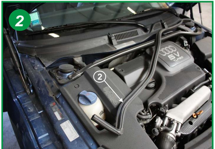
Retirer la quasi-totalité du joint d'étanchéité du compartiment moteur (2).
