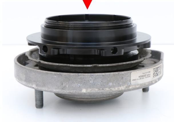
Abb. 1: Das Federschlossgummi wird durch die Höhenverstellung ersetzt
