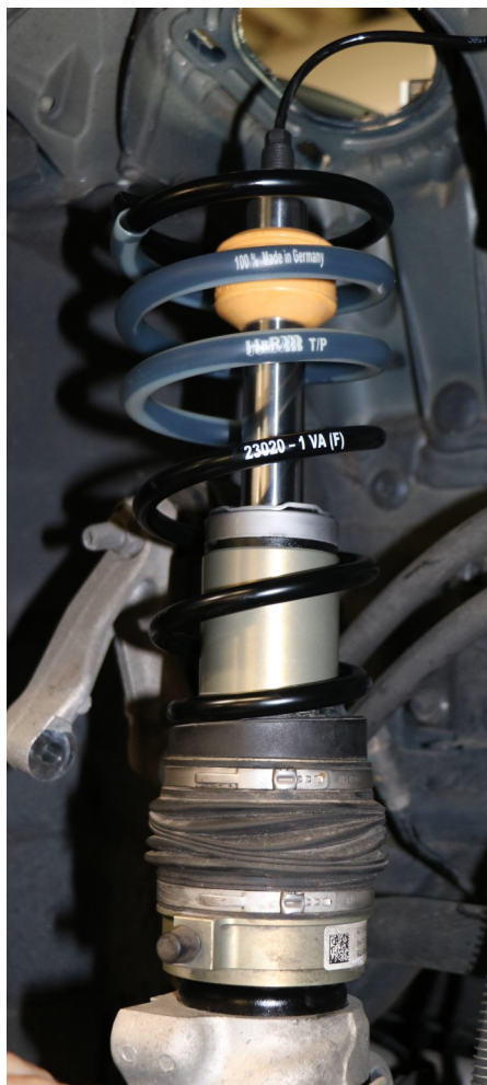
Abb. 4: Federbein im Radträger (Abbildung ähnlich)
