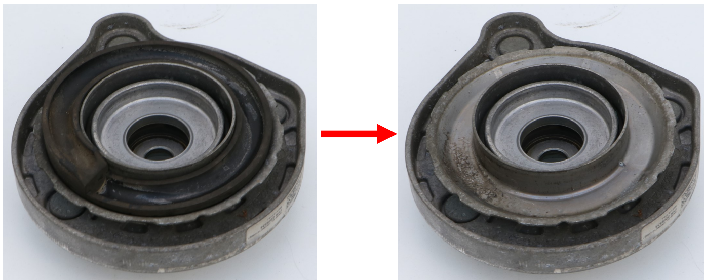
Abb. 1: Das Federschlossgummi wird durch die Höhenverstellung ersetzt
