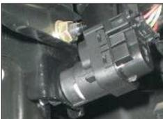
Den Schalter in die Öffnung des Pedalkörpers stecken
