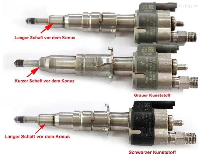
Sollten im Fahrzeug Einspritzventile der 1. Generation (schwarz, kurzer Schaft) verbaut sein, müssen im Schadensfall alle Einspritzventile durch die 2. Generation ersetzt werden. Danach muss ein Softwareupdate erfolgen. Zwingend bei Softwarestand kleiner E060-08-03-525 bzw. E089x-08-03-530!
