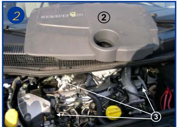
Retirer le résonateur qui couvre le moteur en tirant dessus. Ce résonateur (2) est maintenue en place à l'aide de trois rotules (flèches 3).
