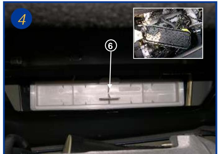
Extraire l'élément filtrant en le tirant par sa poignée(6). Le remontage s'effectue dans l'ordre inverse du démontage.
