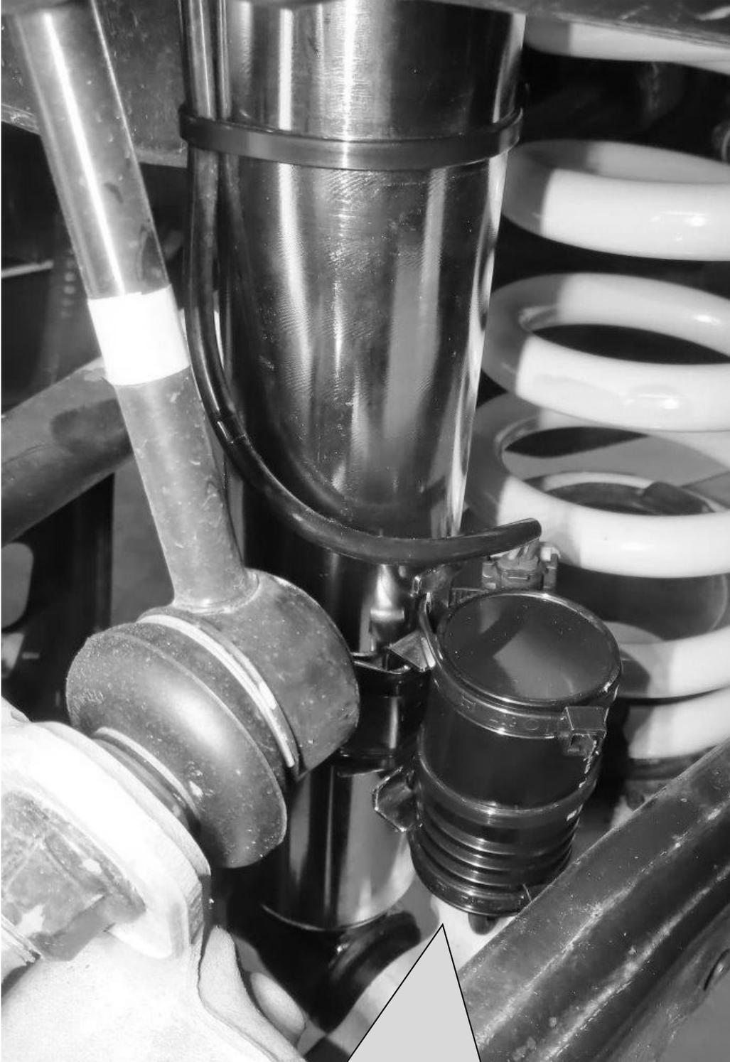
Stilllegung muss in Richtung Fahrzeugheckseite zeigen.
