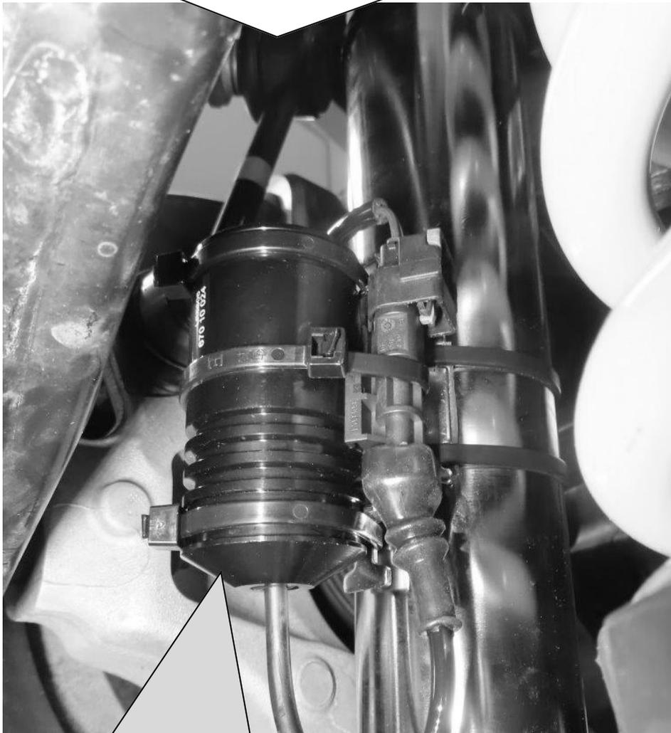
Stilllegung muss in Richtung Fahrzeugheckseite zeigen.
