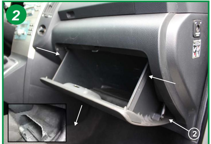
Dévisser la vis cruciforme (2) pour dé-accoupler l'amortisseur de retenue de la boîte à gants. Presser sur ces flancs (voir flèches) et retirer dans sa totalité le tiroir de boîte (voir encadré)
