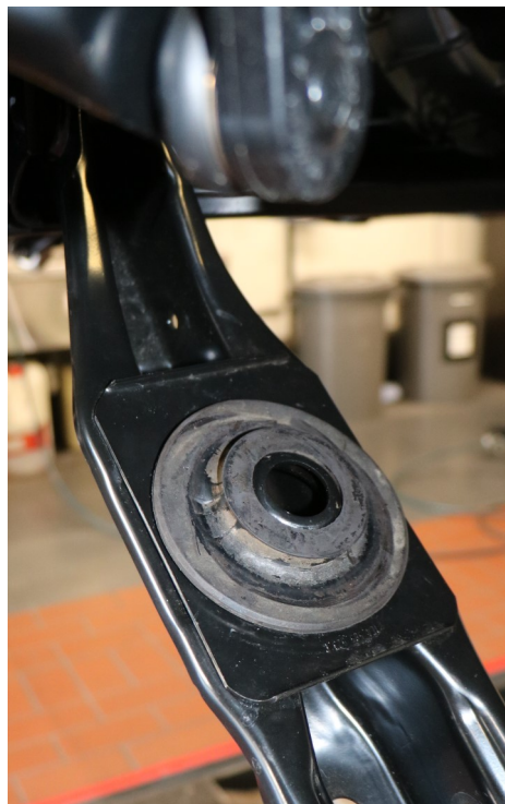
Abb. 2: Das Federgummi ersetzt das Federschloss
