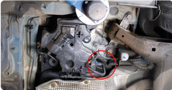
Entfernen Sie die Schutzabdeckung, um an den Zusatzstoffbehälter zu gelangen.
