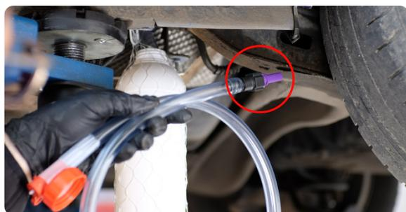
Verbindung mit dem Überlaufschlauch (im BOSAL-Bausatz enthalten).
