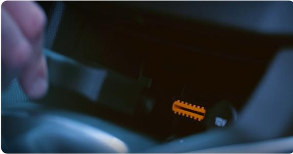
Schließen Sie das Diagnose-Tool an die OBD-Buchse an und suchen Sie die Additiveinstellungen.
