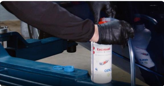
Schließen Sie den Überlaufschlauch an die Additivflasche an. **Stellen Sie die Bosal GEN-Flasche beim Befüllen höher als den Tank.**
