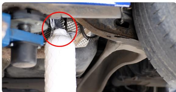
Positionieren Sie die leere Flasche und den kleinen Schlauch (leere Flasche und Zubehör im BOSAL-Kit enthalten).
