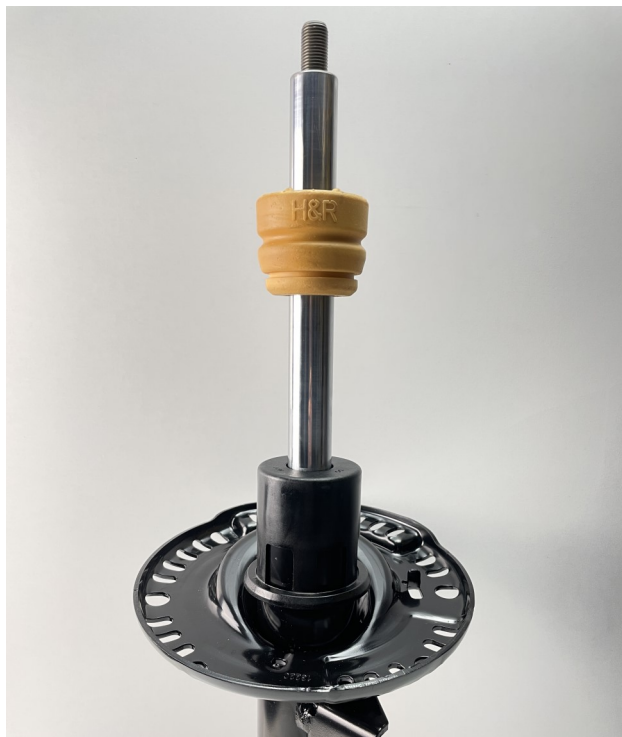
Abb. 1: H&R Anschlagpuffer montieren
