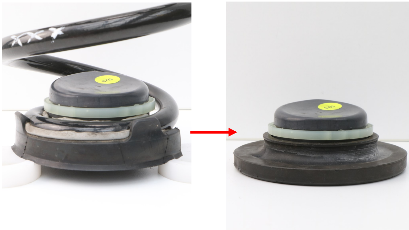
Abb. 3: Untere Federzentrierung wird wiederverwendet und mit dem Federgummi kombiniert
