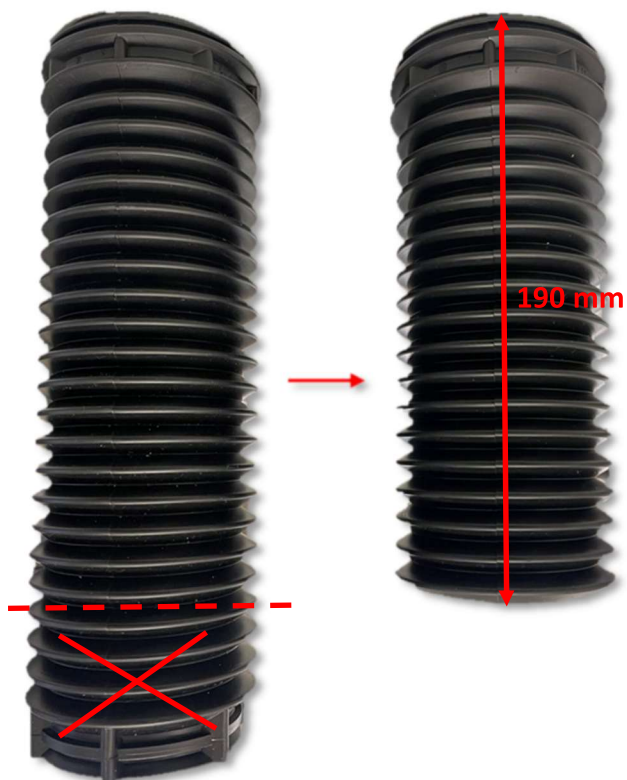
Abb. 1: VA Schutzrohr kürzen (Abbildung ähnlich) Fig. 1: FA shorten dust cover (figure may vary)
