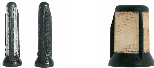
Az E1F előszűrője: balra új, jobbra eldugult állapotban
