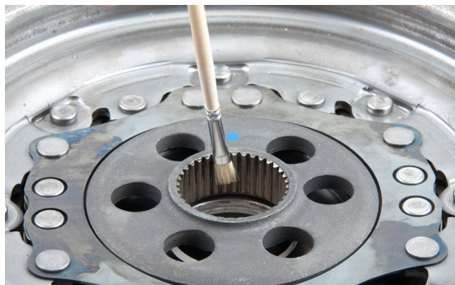
1. ábra: A DMF belső fogzását minden egyes javításkor kissé be kellene zsírozni
