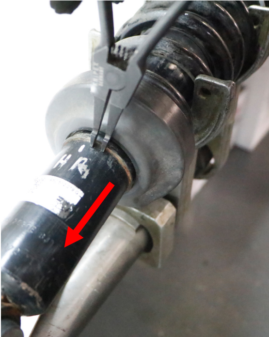
Abb. 8: Sicherungsring nach unten verschieben Fig. 8: Move the locking ring down
