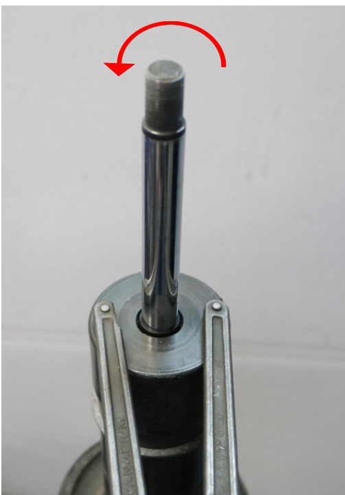
Abb. 3: Abdeckkappe demontieren Fig. 3: Dismantle the cap
