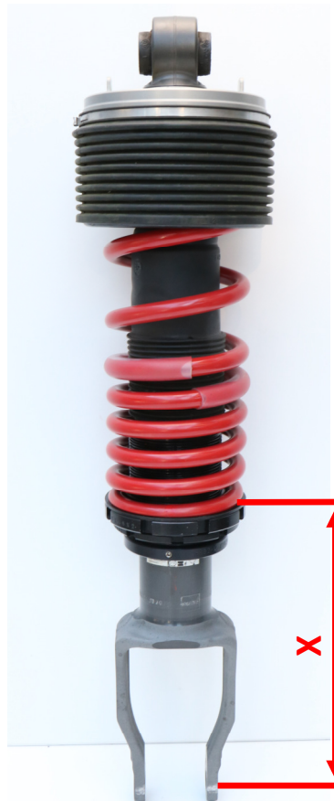
Abb. 7: Einstellmaß X VA (Abbildung ähnlich) Fig. 7: Adjustment dimension X FA (Fig. may vary)
