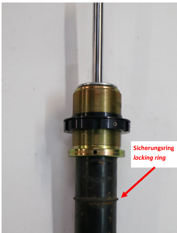
Abb. 10: Sicherungsring und Höhenverstellung montieren (Abbildung ähnlich) Fig. 10: Mount the locking ring and height adjuster (Fig. may vary)
