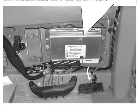
Mitgelieferter Stecker (Adapter) in das Steuergerät einstecken und verriegeln. Insert the supplied plug (adapter) into the control unit and lock.
