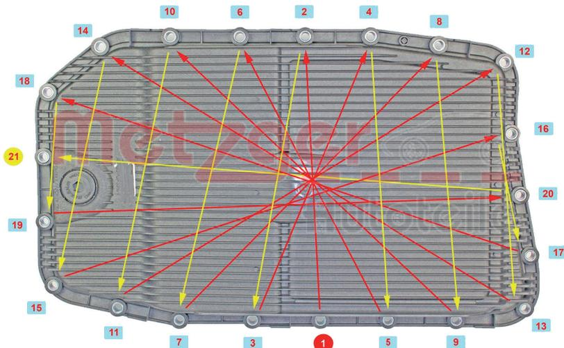
**Anzugsreihenfolge:** Ölwanne am Getriebe ansetzen und alle Schrauben von Hand eindrehen. Den korrekten Sitz der Ölwanne prüfen. Schrauben beginnend bei Position 1 über Kreuz von innen nach außen verschrauben. Drehmoment: 10 Nm. Die Vorgaben des KFZ-Herstellers sind zu beachten.
