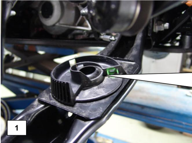
Federteller unten entfällt und wird durch den mitgelieferten Federteller M45-85-052-01-01 ersetzt, siehe Bild 2.
