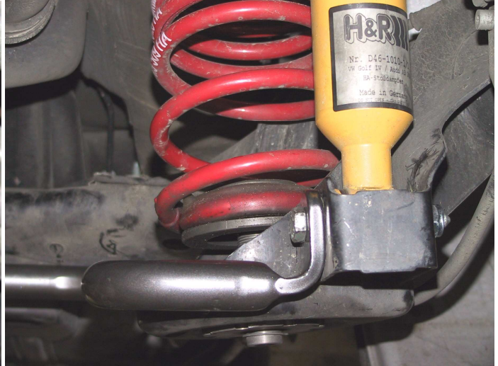
Abbildung/figure 2: Befestigen des Stabis an der Stoßdämpferaufnahme /adjustment of the stabilizer at the shock absorber mount
