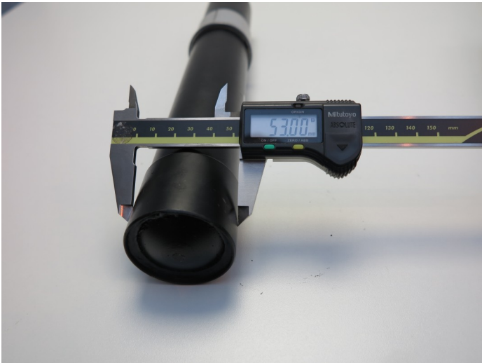
Abb. 1: VA-Dämpfer Durchmesser 53 mm Fig. 1: FA shock absorber diameter 53 mm
