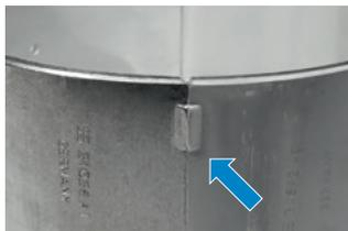
Rechteckige Fixiernocken bei Gleitlagerschalen von Kolbenschmidt
