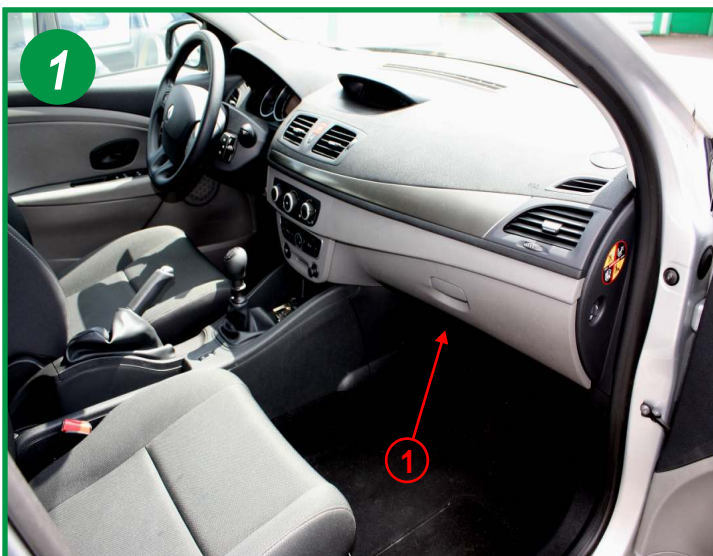
Le filtre d'habitacle est situé à l'intérieur du véhicule, coté passager, derrière la boîte à gants (1)
