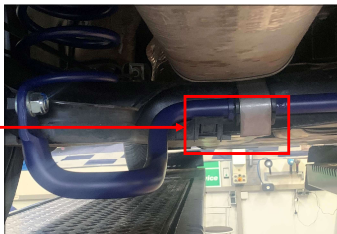
Abb. 5 & 6: Ausklinken des Steinschlagschutzes (fahrzeuginnere Klemmbefestigung wird entfernt)
