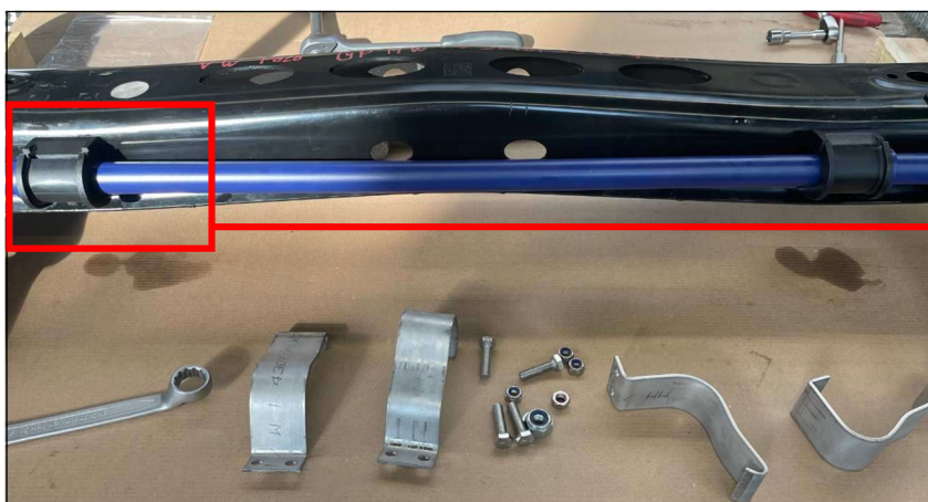
Abb. 3 & 4: Lagergummi Positionierung durch Stellringe
