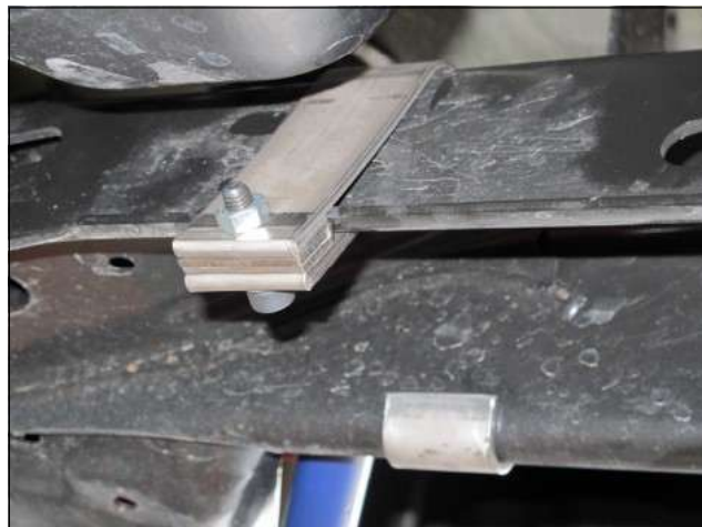
Abb. 2: Montage des Schellensystems Fig. 2: Mounting of the brackets
