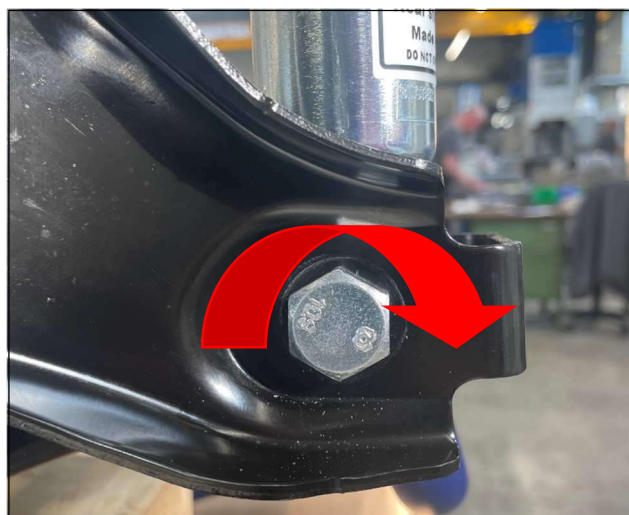
Abb. 10: Anziehen der HA-Stoßdämpferschraube
